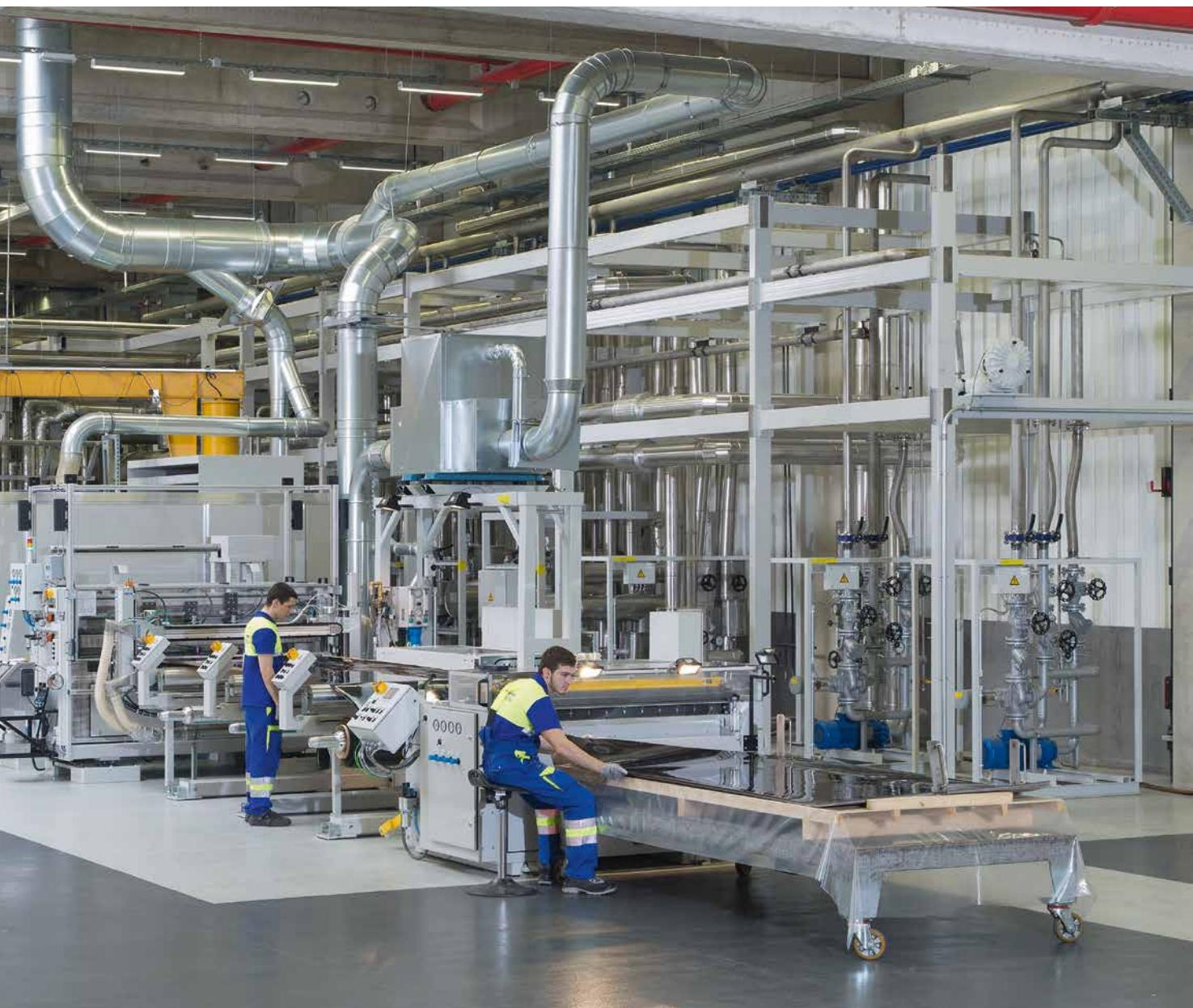
Rolne impregniranog papira učvršćuju se na vretena koja ulaze u zonu presovanja. Primenom visoke temperature i pritiska dolazi do stvrdnjavanja smole. Poprečnim vezivanjem smola dobija se izuzetno homogen dekorativan i strukturiran materijal sa neporoznom površinom.
