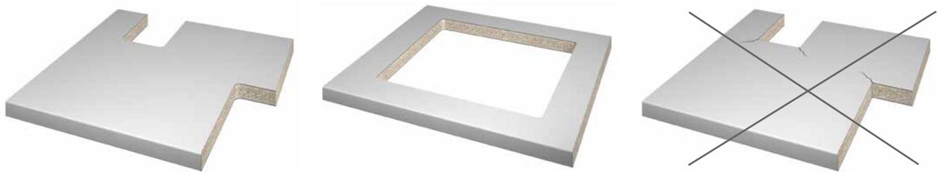
Za **rezanje** treba koristiti prenosnu ručnu glodalicu ili CNC gladalicu. Kod izrezivanja ubodnom pilom treba raditi sa donje strane ploče. I ovde je potrebno prethodno izbušiti uglove. Zatim se reže od ugla do ugla. Na kraju, ivice treba izbrusiti, isturpijati ili ručno obraditi kako bi se izbegle pukotine. Izrezivanje zaobljenih delova i zaobljenih uglova je jednostavnije.
