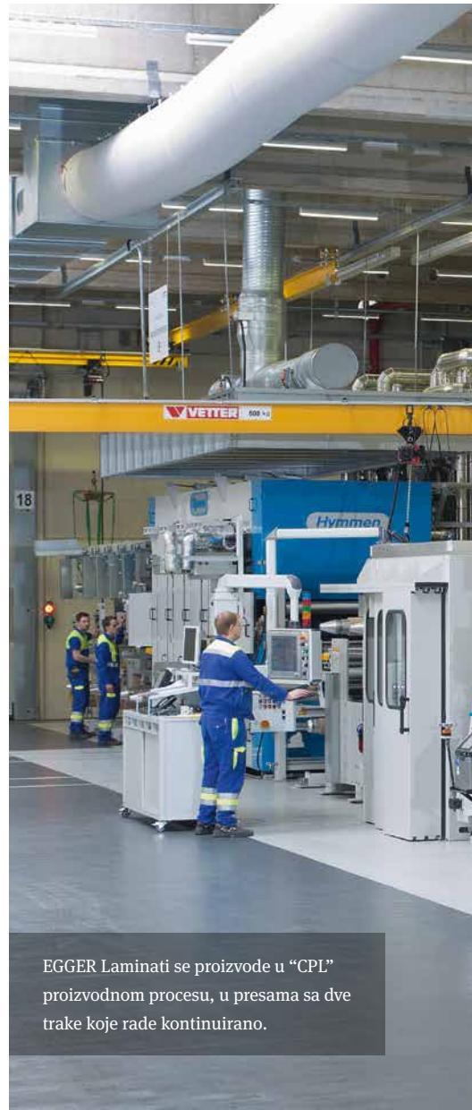
EGGER Laminati se proizvode u "CPL" proizvodnom procesu, u presama sa dve trake koje rade kontinuirano.
