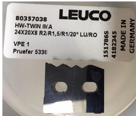
Fotografija izmenjene geometrije alata. Deo radijusa alata je uklonjen. Preostali deo radijusa od 2 mm meri 0,95 mm nakon sečenja.
